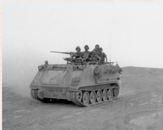
שבטה. נגמ"ש של מח' 3. בתמונה ניתן לראות חלק מחימוש הנגמ"ש, זיורדו וצוותו. הנהג מציץ מלפנים מתאו, בצריחון הקדמי מפקד הנגמ"ש עם מק"כ 0.5, בתא הלחימה מאג שמאל ומאג ימין (שרובו מוסתר), מאחור מונח מקלעון FN עם דורגלים פתוחים. לצד הנגמ"ש קשורה רשת הסוואה ומלפנים, מעל מכסה המנוע מותקנת את חפירה. משמאל לתא המנוע שתי חוליות זחל להחלפה
